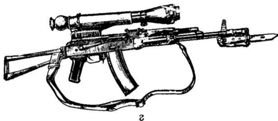
Общий вид 5,45-мм автомата Калашникова: а - с постоянным прикладом (АК74); б - со складывающимся прикладом (АКС74); в - с постоянным прикладом и ночным прицелом (АК74Н); г - со складывающимся прикладом и ночным прицелом (АКС74Н).
